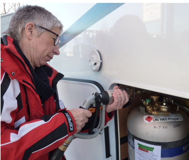
Poser (visser) le pistolet sur l'adaptateur Photo 5
