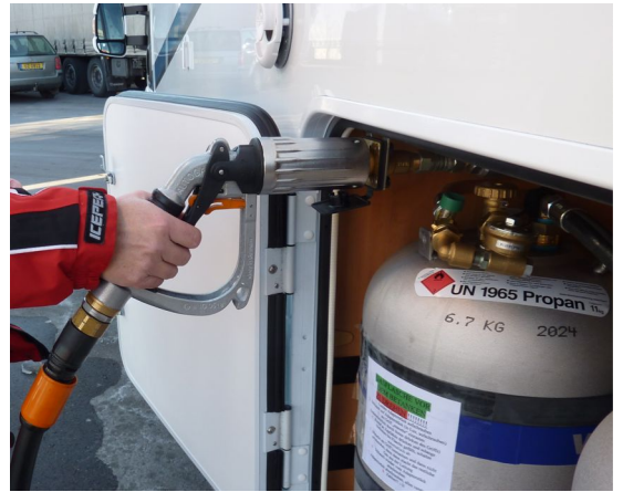
Déclencher la manette du pistolet Photo 8 Un sifflement sec retentit.
