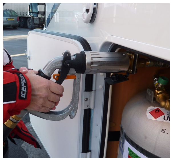
Enclancher la manette du pistolet et arrêter par le pivot orange Photo 6
